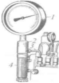
1 - манометр; 2 - корпус; 3 - топливопровод; 4 - предохранительный клапан форсунок дизельных двигателей
