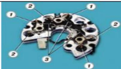
11. Укажите номера позиции деталей, отвечающих за преобразование переменного тока в постоянный: \_\_\_\_\_
