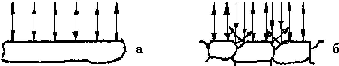
Рисунок 1 - Схема отражения световых лучей от поверхности полированного (а) и подвергнутого травлению (б) микрошлифа.
