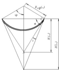
Рис. 3. Схема к определению предельных углов атаки диска
