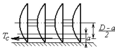
Рис. 5. К определению опрокидывающего момента, действующего на секцию
