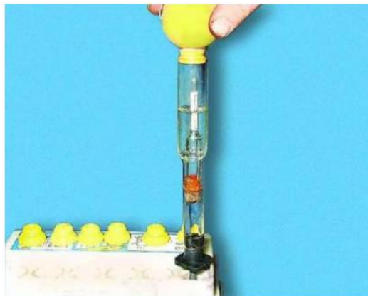
Рис. 2. Проверка плотности электролита ареометром
