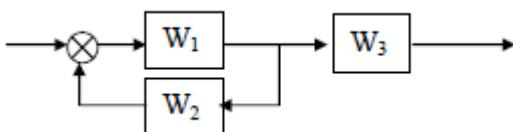
Передаточная функция для данного соединения звеньев равна:
