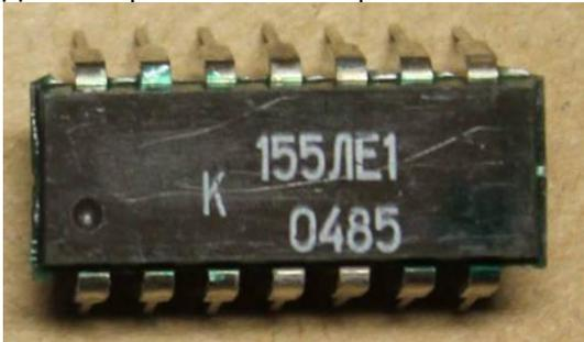
Для получения RS-триггера, у которого инверсный выход  $\bar{Q}$  соответствовал бы выводу 6, а выводы 1 и 5 – входам R и S соответственно, следует соединить перемычками выводы 1, 2, 3, 4, 5, 6 (нижний ряд - нумерация слева на право) следующим образом:
