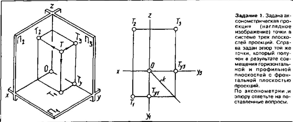
**Задание 1.** Задана аксонометрическая проекция (наглядное изображение) точки в системе трех плоскостей проекций. Справа задан эюпор той же точки, который получен в результате совмещения горизонтальной и профильной плоскостей с фронтальной плоскостью проекций. По аксонометрии и эюпору ответьте на поставленные вопросы.
