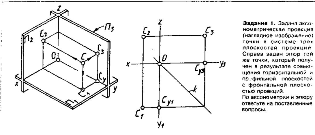
**Задание 1.** Задана аксонометрическая проекция (наглядное изображение) точки в системе трех плоскостей проекций. Справа задан эпюр той же точки, который получен в результате совмещения горизонтальной и пр. профильной плоскостей с фронтальной плоскостью проекций. По аксонометрии и эпюру ответьте на поставленные вопросы.
