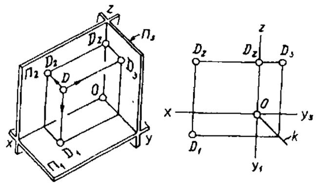
**Задание 1.** Задача аксонометрическая проекция (наглядное изображение) точки в системе трех плоскостей проекции. Справа задан эюр той же точки, который получен в результате совмещения горизонтальной профильной плоскости с фронтальной плоскостью проекции. По аксонометрии и эюру ответьте на поставленные вопросы.
