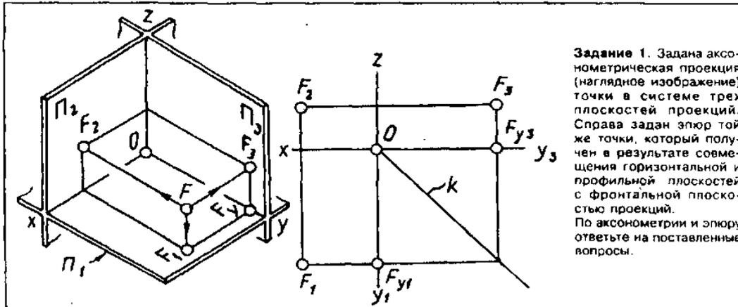
**Задание 1.** Задана аксонометрическая проекция (наглядное изображение) точки в системе трех плоскостей проекций. Справа задан эпюр той же точки, который получен в результате совмещения горизонтальной и профильной плоскостей с фронтальной плоскостью проекций. По аксонометрии и эпюру ответьте на поставленные вопросы.
