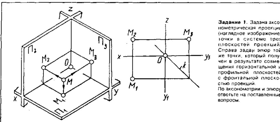
**Задание 1.** Задаана аксонометрическая проекция (наглядное изображение) точки в системе трех плоскостей проекций. Справа задан эпюр той же точки, который получен в результате совмещения горизонтальной и профильной плоскостей с фронтальной плоскостью проекций. По аксонометрии и эпюру ответьте на поставленные вопросы.
