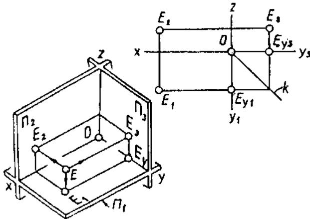
**Задание 1.** Задана аксонометрическая проекция (наглядное изображение) точки в системе трех плоскостей проекций. Справа задан эпор той же точки, который получен в результате совмещения горизонтальной и профильной плоскостей с фронтальной плоскостью проекций. По аксонометрии и эпюру ответьте на поставленные вопросы.
