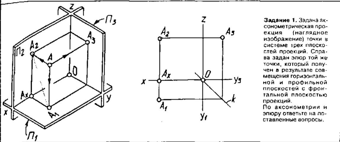
**Задание 1.** Задана аксонометрическая проекция (наглядное изображение) точки в системе трех плоскостей проекций. Справа задан эюр той же точки, который получен в результате совмещения горизонтальной и профильной плоскостей с фронтальной плоскостью проекций. По аксонометрии и эюру ответьте на поставленные вопросы.
