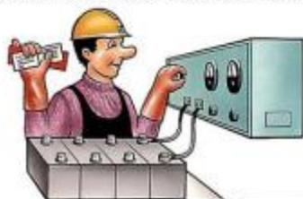
**ПРИСОЕДИНЯТЬ И ОТСОЕДИНЯТЬ КЛЕММЫ МОЖНО ТОЛЬКО ПРИ ВЫКЛЮЧЕННОМ ВЫПРЯМИТЕЛЕ**
