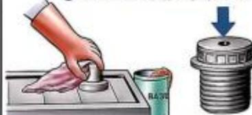
2 Очистите батарею и клеммы от электролита и протрите их насухо. Клеммы смажьте техническим вазелином
