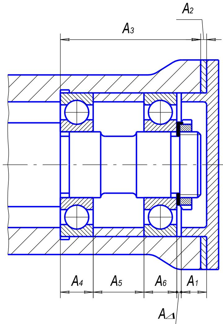
Назначить допуски и отклонения составляющих размеров с таким расчетом, чтобы обеспечить значение замыкающего размера равное
