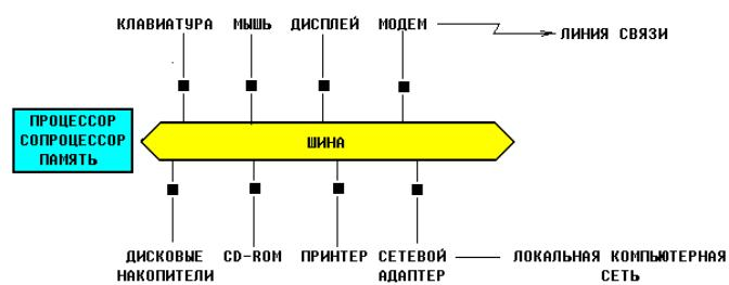
На этой схеме шина изображена в виде двунаправленной стрелки, чтобы указать на то, что информация по ней движется как от процессора к периферийным устройствам, так и в обратную сторону. Чёрными квадратиками обозначены разъёмы. Схема носит условный характер, иллюстрирующий только основные принципы устройства современного компьютера, поэтому ряд устройств, в частности видеoadаптер, здесь не изображены.
