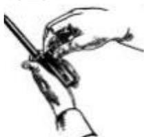
Затворную раму с затвором, нужно разделить на две части (на саму затворную раму и на затвор). Взять затворную раму в левую руку затвором сверху; правой рукой отвести затвор назад, повернуть его так, чтобы ведущий выступ затвора вышел из фигурного выреза затворной рамы, и вывести затвор вперед.
